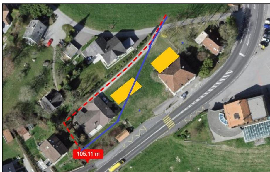
La transformation de l'ancienne auberge des « Trois Rois » avec la construction d'un couvert à voitures et le réaménagement de l'accès nécessite le déplacement de la conduite communale d'eau potable avant la fin des travaux.
