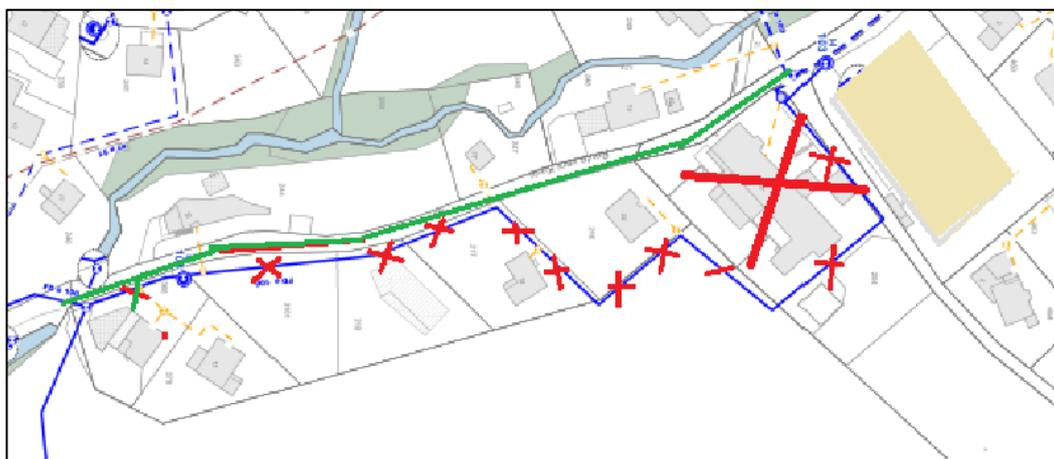
La construction du nouveau foyer Horizon Sud devrait débuter en automne 2021 sur un nouvel emplacement à l'arrière du bâtiment existant. Ce dernier sera démoli à la fin des travaux pour faire place à la modification du tracé de la route de la Grangette et au parking de l'institution. Cela implique le déplacement de la conduite d'eau communale, laquelle se trouve dans les aménagements prévus et les aménagements des constructions en aval.
